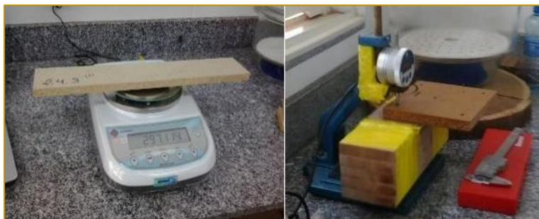
O inchamento em espessura e a absorção de água
