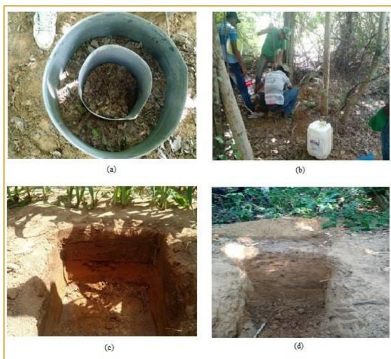
O cilindro interno apresenta diâmetro de 25 cm e o externo de 50 cm. O procedimento consiste em cravar os anéis verticalmente no solo mantendo uma lâmina de água de 200 – 250 mm, com a altura da lâmina de água medida com uma régua verticalmente colocada no centro do anel interno e medida em intervalo de tempo regular (Bernardo *et al.*, 2008).
